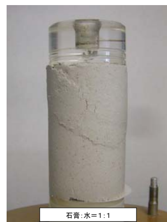
写真-1 せん断後の供試体の状況 容積比 1 (重量比 1.5)
